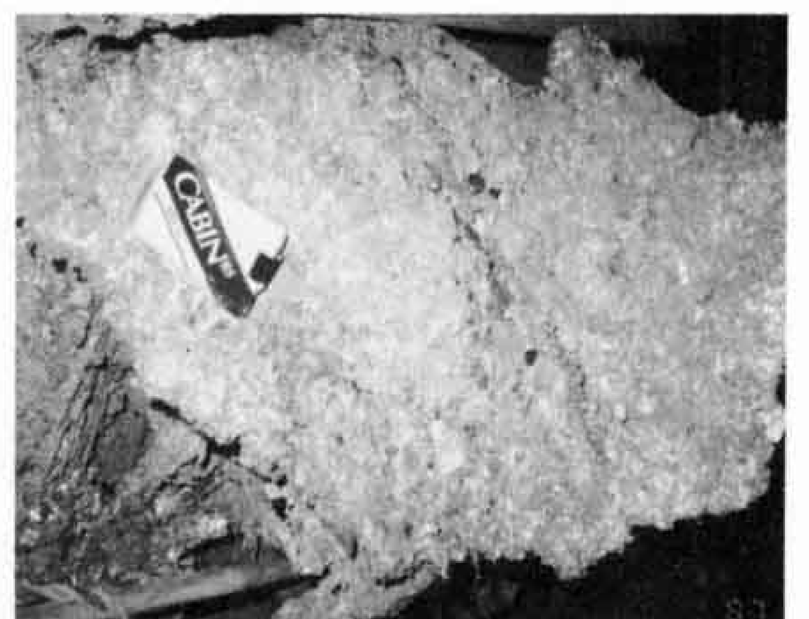
△炉の底にたまったアルミニウム
