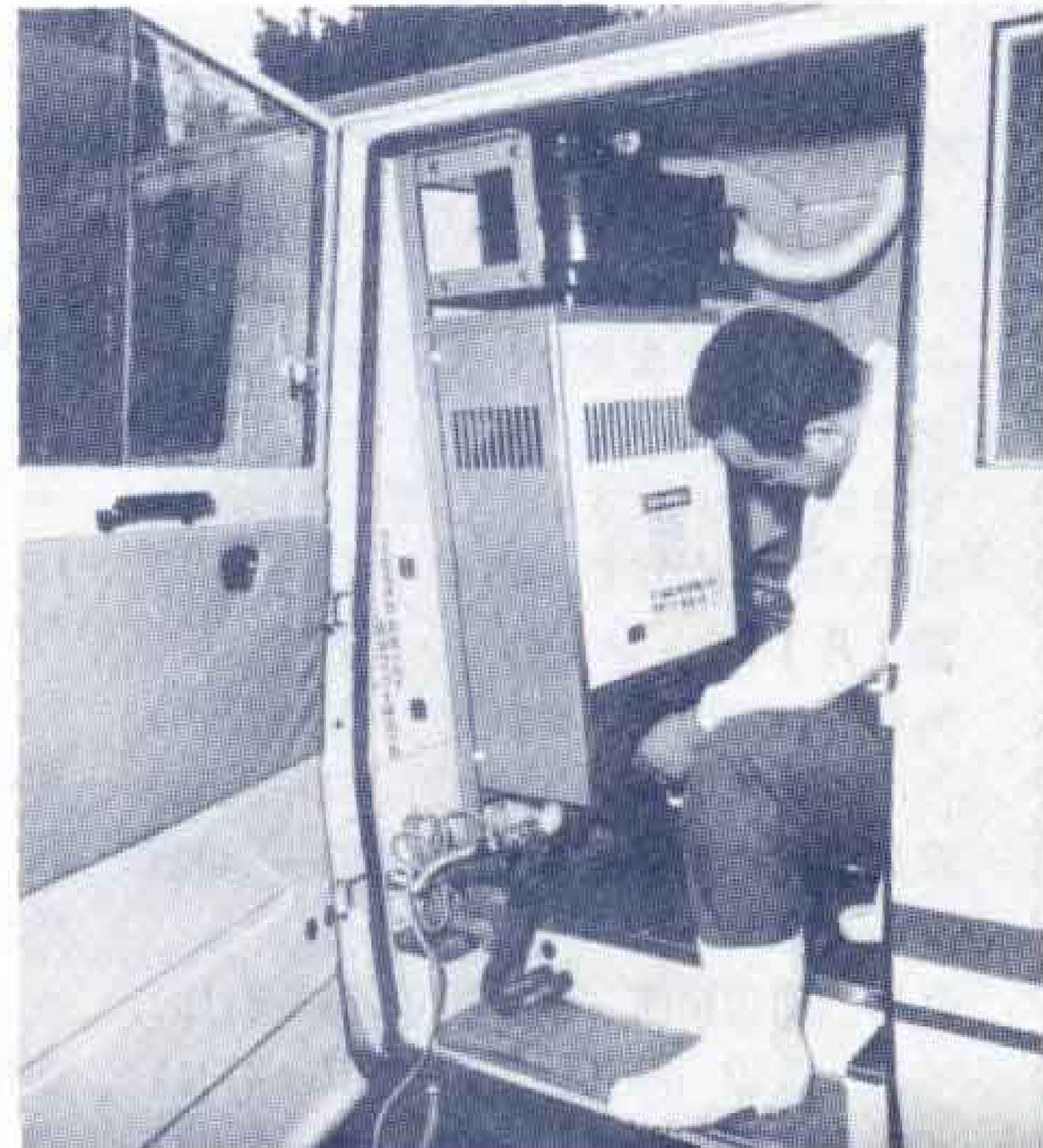
【車から浴槽を家の中に運び入れ、車の中でお湯を沸かし給湯する】
