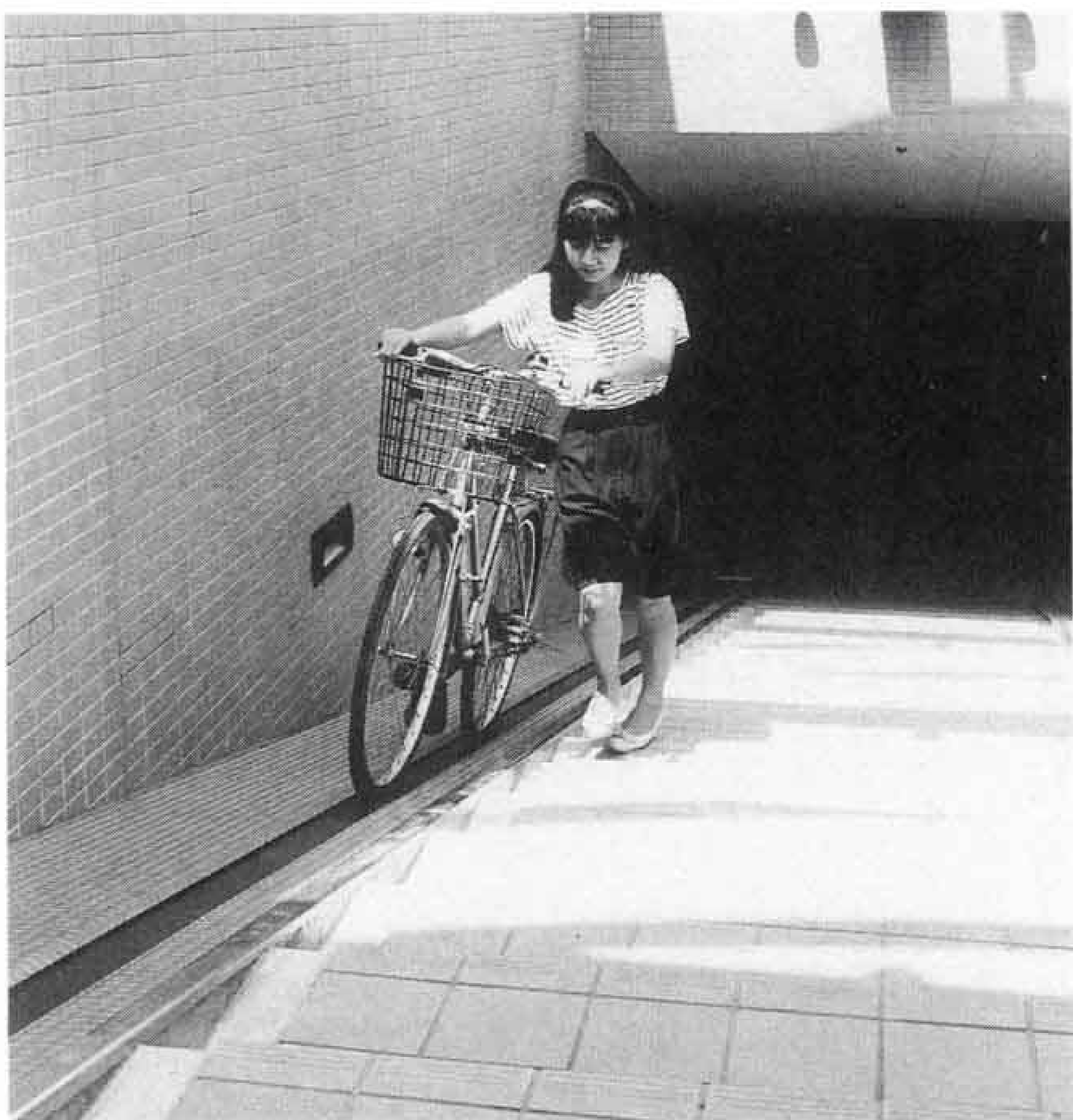
←自転車を押し坂を上げるのを助けるため、サイクルラインというベルトコンベアに乗せて出口から出ます
