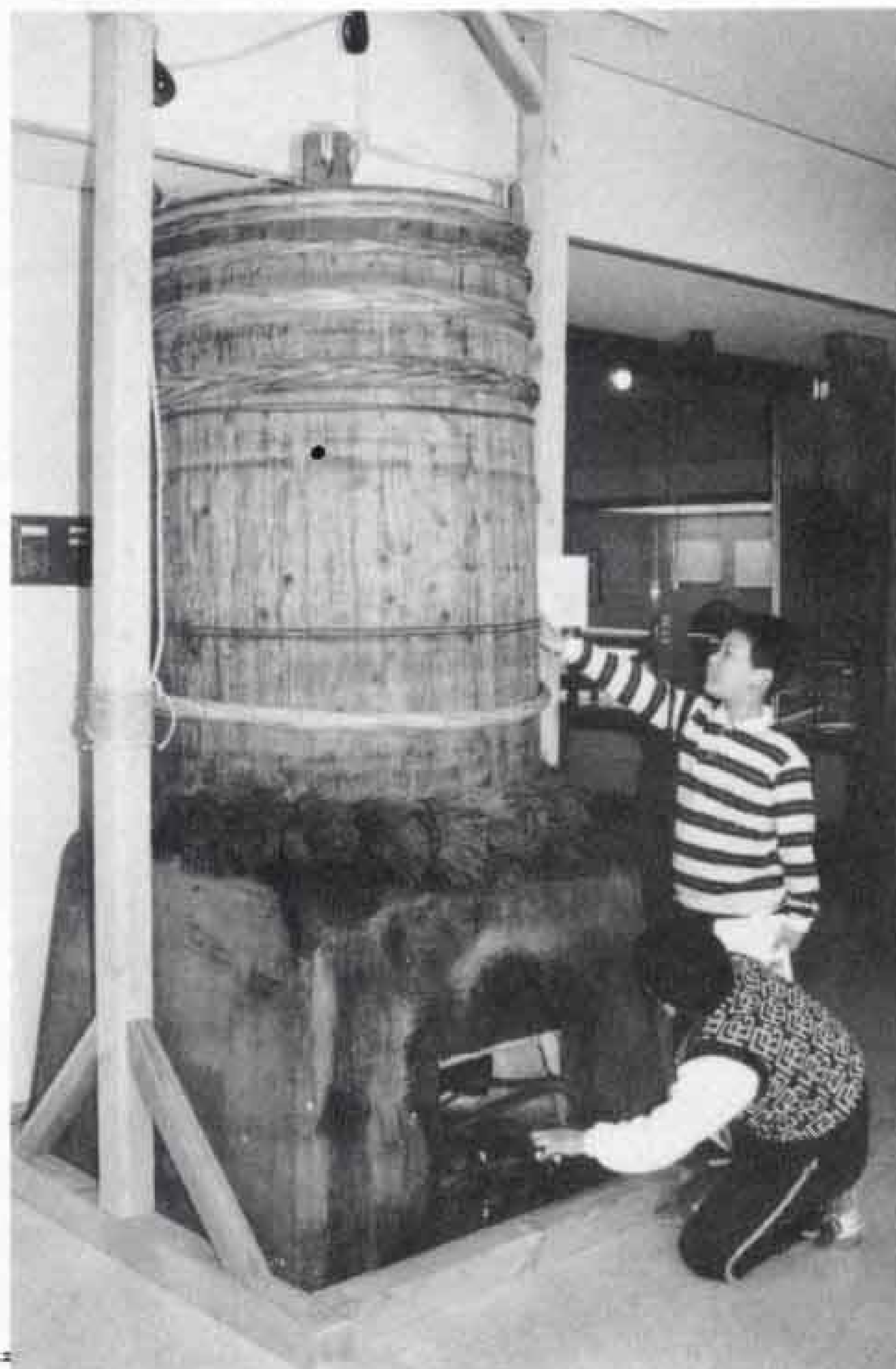
みつまた ▽三極など紙の材料を蒸したかま(模型)
