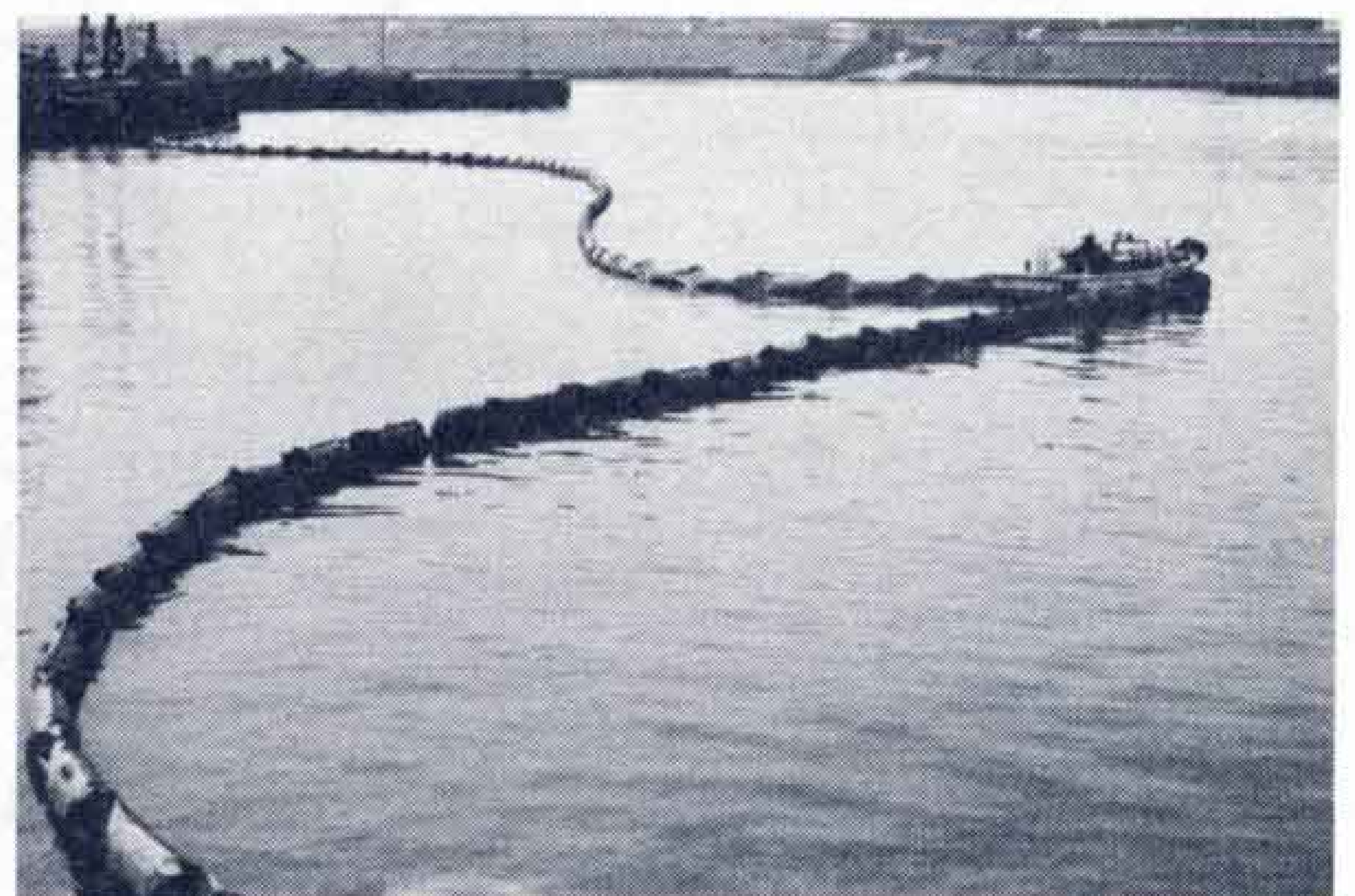
▽オイルフェンスで油の流失防止訓練
