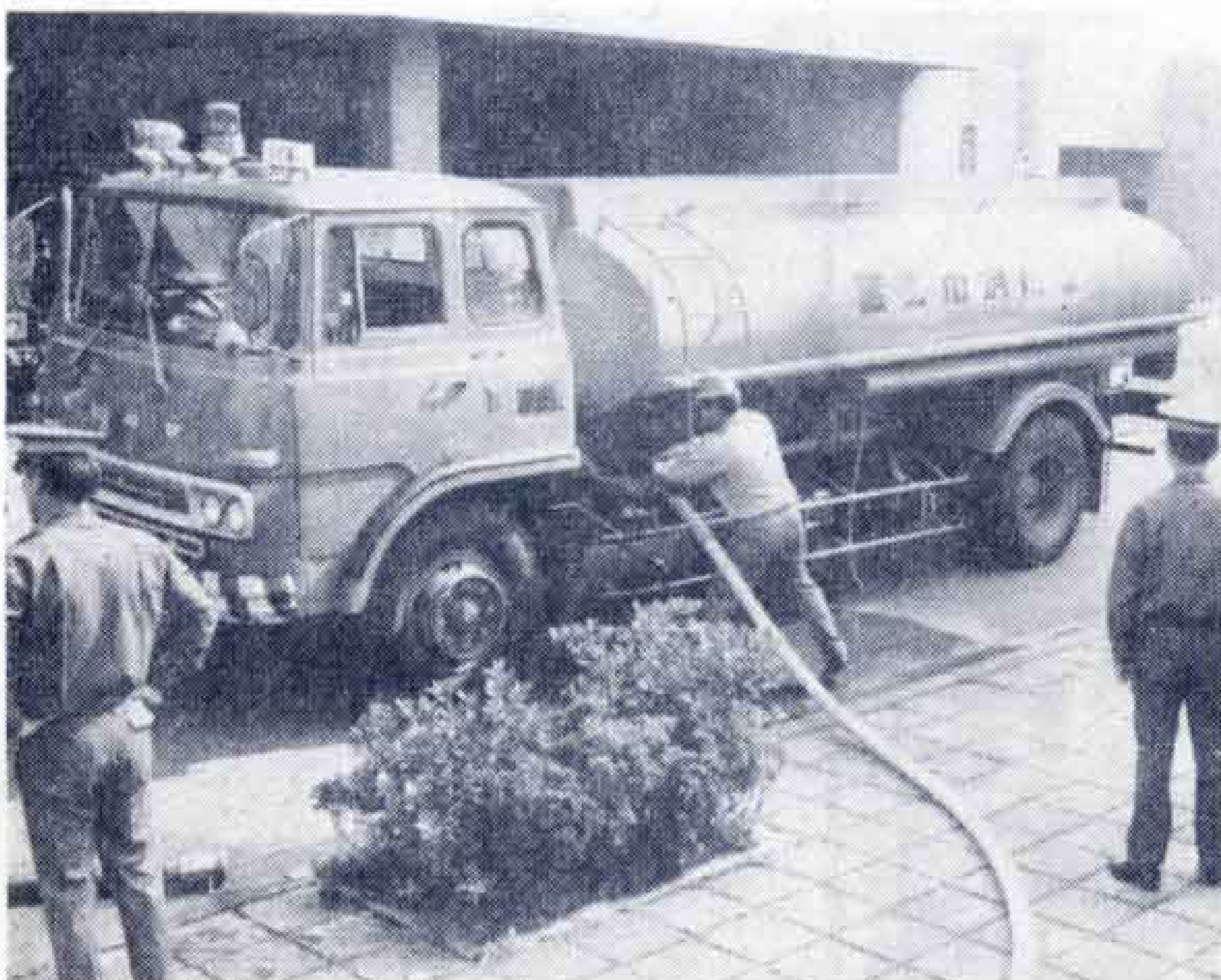
【タンクローリーを改造した水槽消防自動車】
