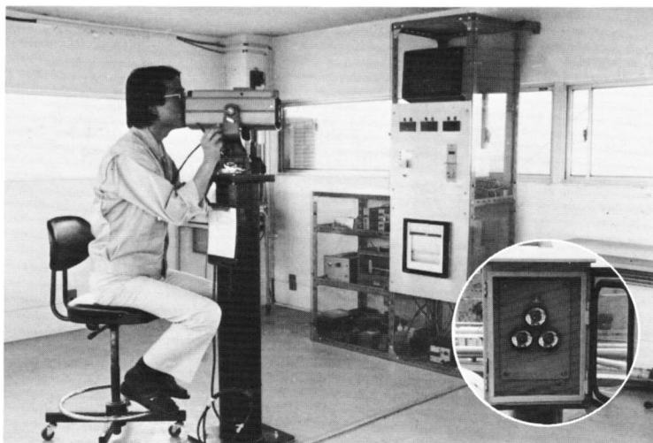
役場の塔最上階の観測室（中央がレーザー光線を利用した波測測儀・同測距儀の右側が気象観測装置）また右下の写真は富士市に三ヶ所と当町に一ヶ所設置されている反射プリズム。
